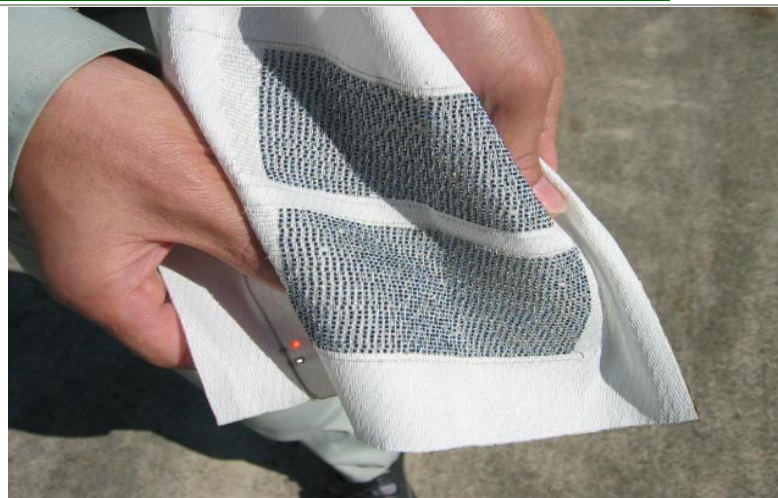
太陽光発電糸を用いて織った、軽くて薄くてフレキシブルな太陽光発電テキスタイル
