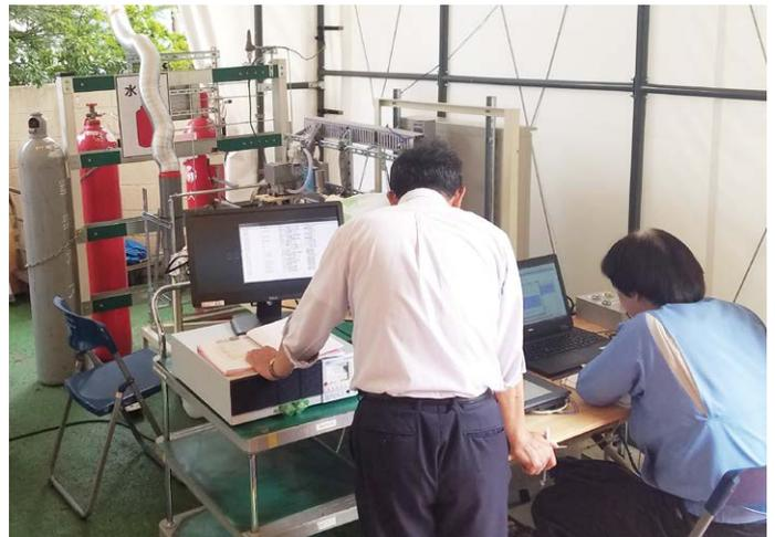
試作機による発電検証状況
